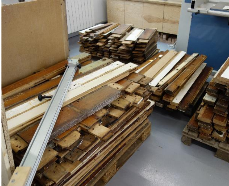
Déclinaison 2 : Traverses hautes et basses des portes palières = treillage en clôture de terrasse. Phase atelier façonnage
